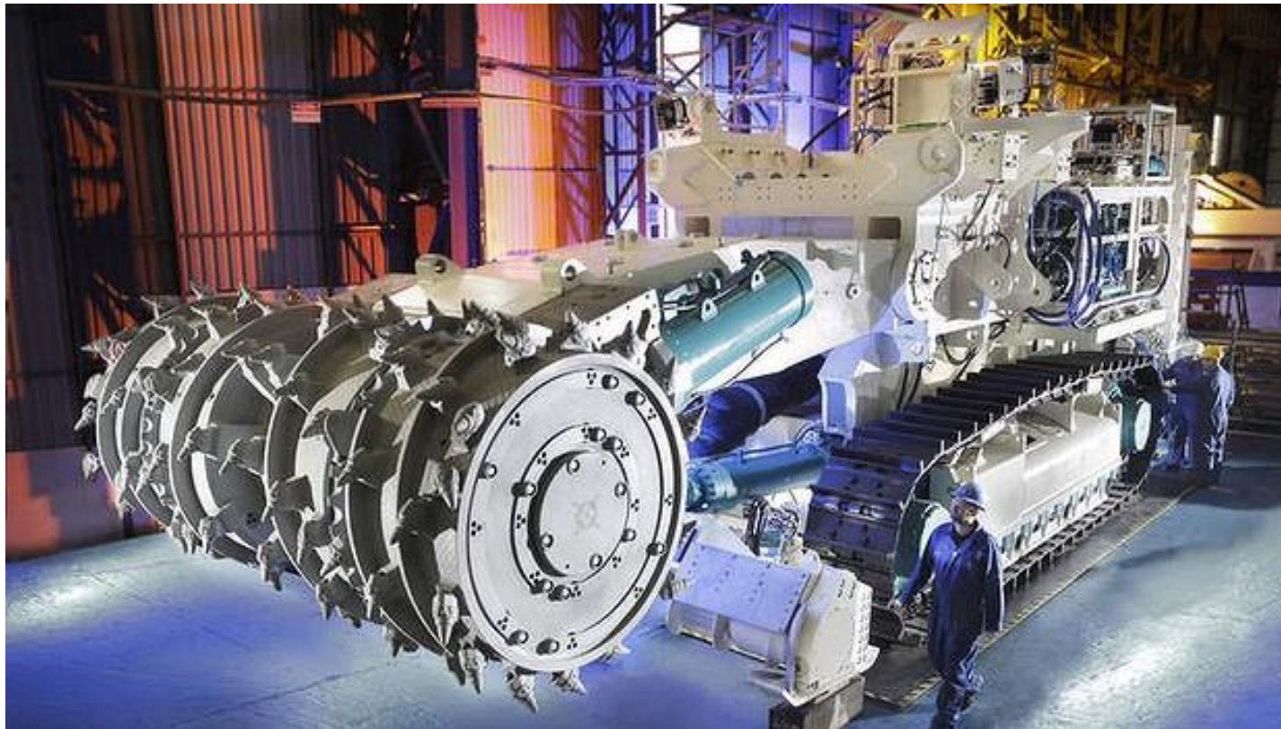
Gesteinsfräse "bulk cutter", gebaut im britischen Newcastle-upon-Tyne für den weltweit ersten Versuch im Tiefseebergbau (Foto: Nautilus Minerals)
