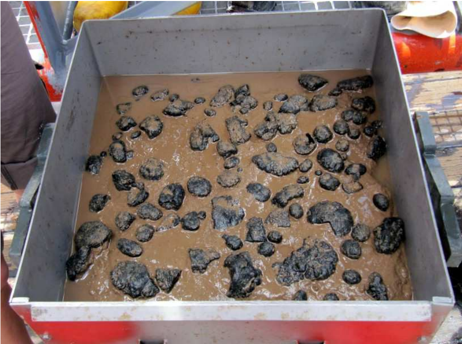
Foto: pa Aufnahme eines sogenannten Kastengreifer, der ein 50 x 50 Zentimeter großes und rund 40 Zentimeter tiefes Stück Meeresboden mit Manganknollen aus dem Pazifik ausgestanzt hat
